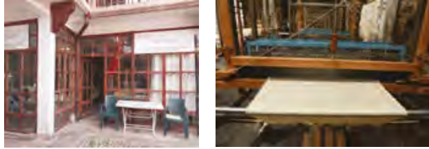
Fotoğraf: 7. a) Nallıhan’daki (Sof dokuyan kadınlar projesi) dokuma atölyesi, b) Sof tezgâhı (4 gücülü), Nallıhan, (Proje ekibi,2023)
