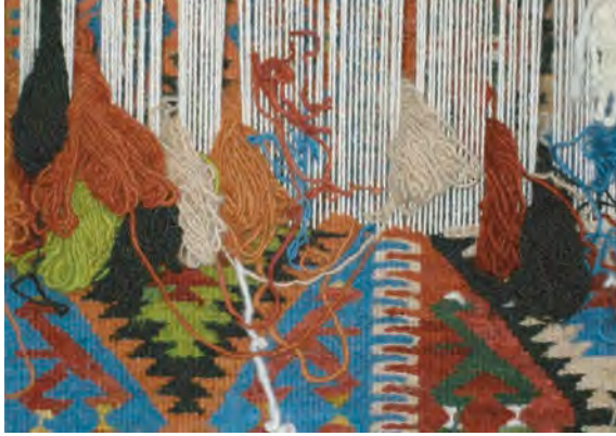
Fotoğraf: 2. Istar tezgahında farda (ilikli kilim) kilim dokuma ve desenleme (Foto: Atlıhan, 2009)
