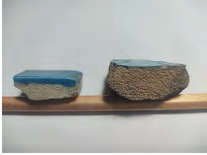
Fotoğraf: 12. Yaş iken kesilip sırlanan ve plakadan kesilen çini parçası
