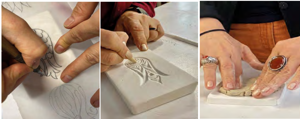
Fotoğraf: 13-14-15. Motif çizimi, Motifin alçıda oyulması, Oyulan motife çamur basım
