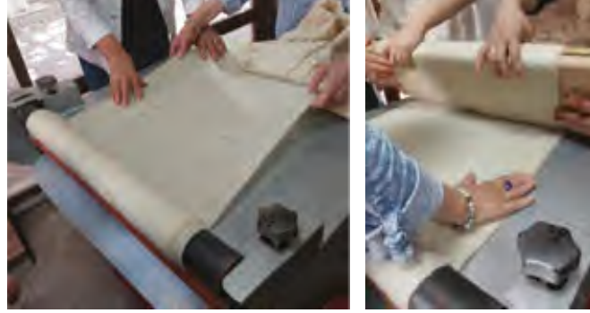
Fotoğraf: 13. a) Sıkma ve b) düzleştirme işlemi, Nallıhan (Proje Ekibi, 2022).
